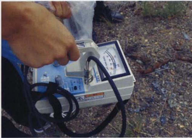
図4-1 核実験における放射線量の測定
